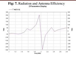
Fig: 8. Z-Parameter of Antenna
